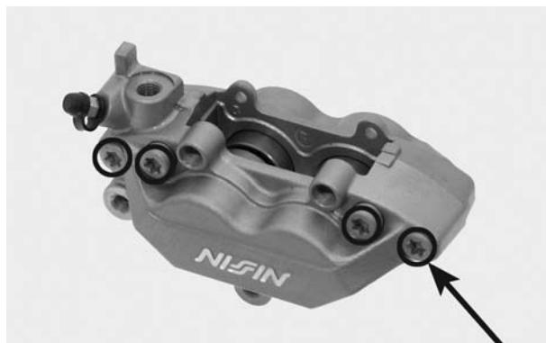
PARAFUSOS DE MONTAGEM PISTÕES DO CÁLIPER
