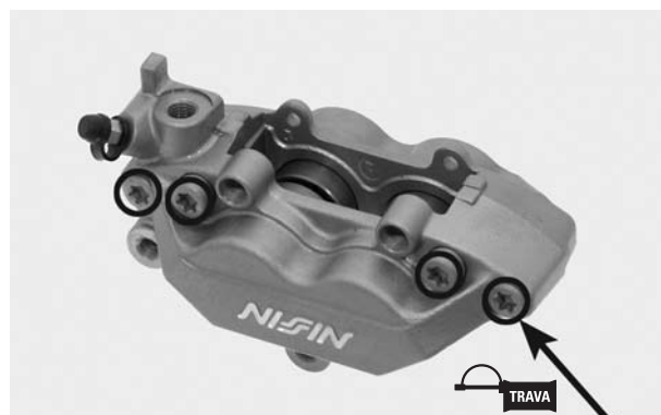
PARAFUSOS DE MONTAGEM PINOS DAS PASTILHAS PARAFUSOS DE FIXAÇÃO
