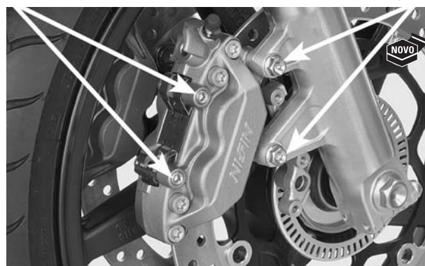
PARAFUSOS DE MONTAGEM PINOS DAS PASTILHAS PARAFUSOS DE FIXAÇÃO
