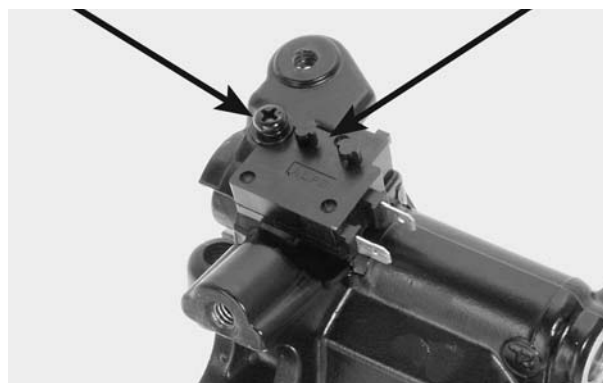
PARAFUSO INTERRUPTOR DA LUZ DO FREIO
