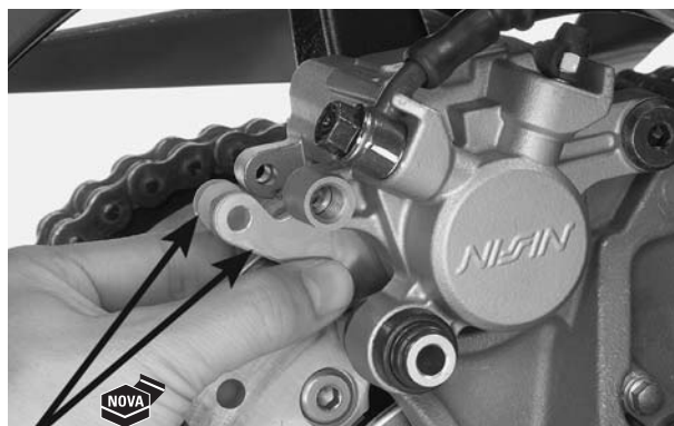
PASTILHA DE FREIO PASTILHAS DE FREIO ANEL LIMITADOR
